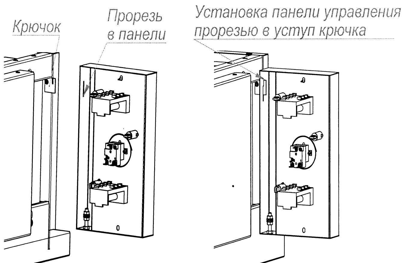
Рис.10 Схема установки панели управления при ТО
