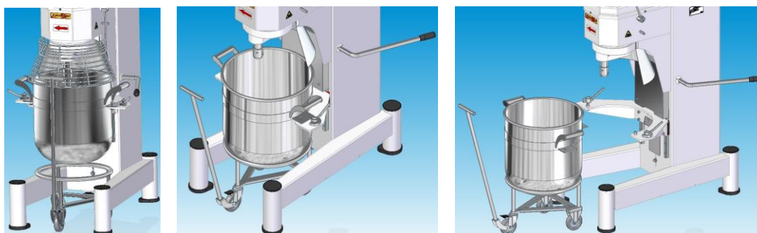
Рис. 6 Установка/извлечение дежи при помощи тележки
